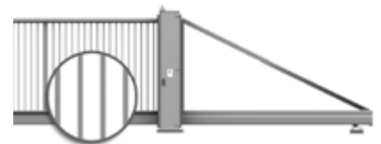
WYPEŁNIENIE W POSTACI KSZTAŁTOWNIKÓW ZAMKNIĘTYCH 30 x 18 [mm] SPAWANYCH DO KONSTRUKCJI.
